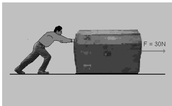
Figura 235. Hombre empujando un baúl en la dirección x positiva con una magnitud de fuerza de 30 \text{ N} . Esta última alcanza a desplazarlo una distancia de 20 \text{ m} en un tiempo de dos segundos. Fuente: elaboración propia
